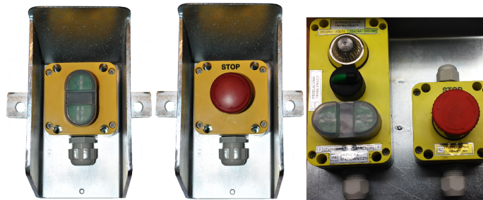
Przyciski sterownicze zamontowane w osłonie
